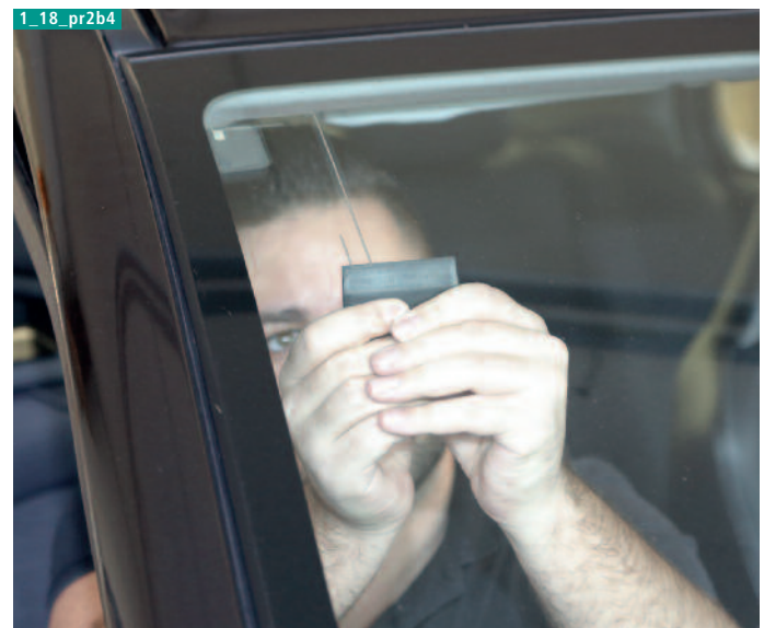
Bild 4. Die Klebefolie des Antennenstrahlers wird mithilfe eines Kunststoffschabers glattgestrichen.
