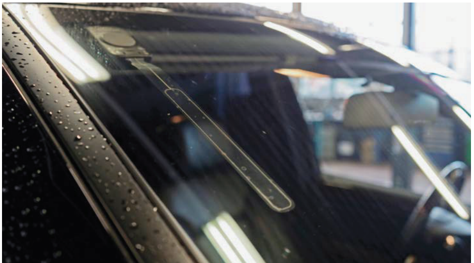
La solution la plus simple pour la conversion : une antenne sur le pare-brise.
