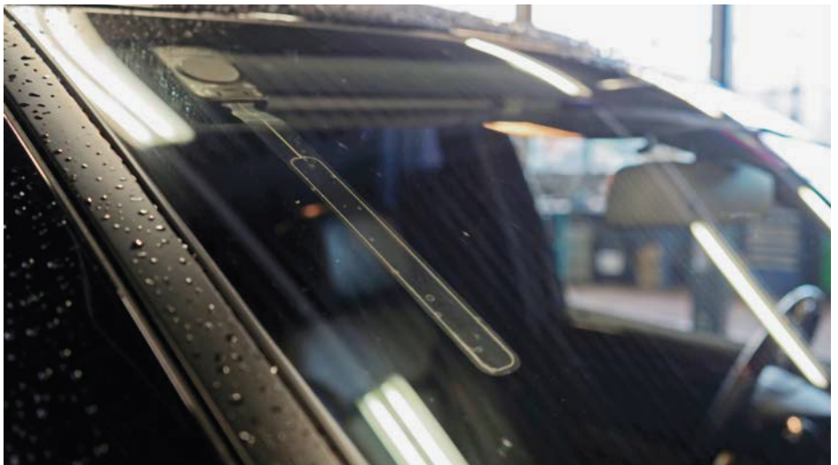
Die einfachste Lösung für die Umrüstung: Eine Antenne an der Frontscheibe.
