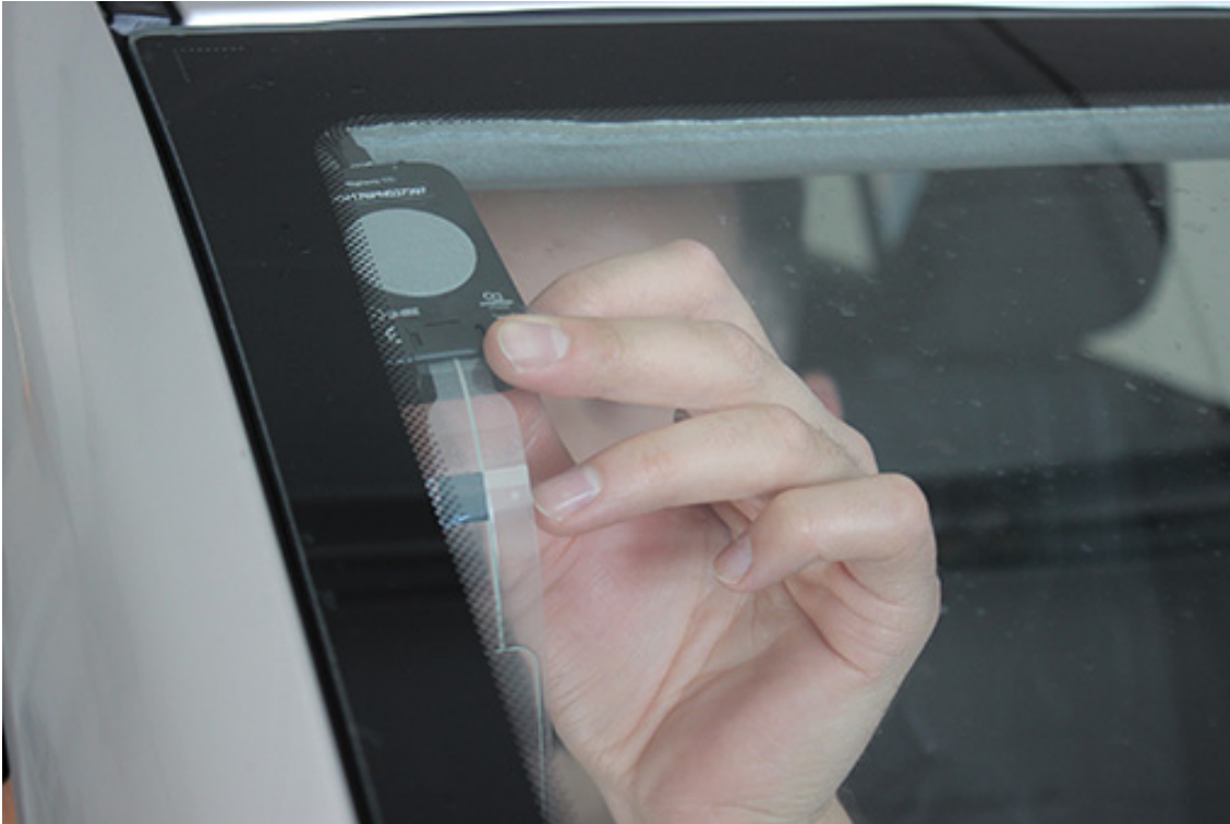
Sorgfältig wird die DAB-Antenne an der Frontscheibe angebracht.
